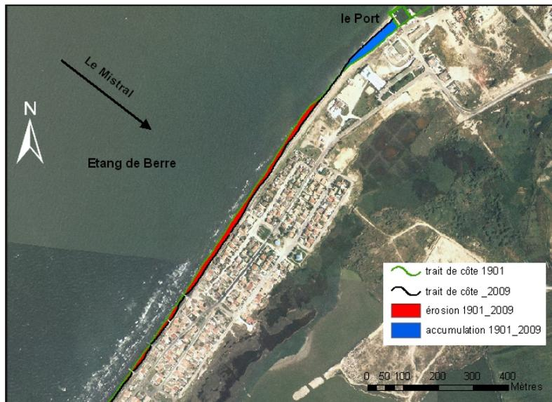
Fig. 34. Variations du rivage durant le XXème siècle. Les zones en érosion et en accumulation forment une cellule de dérive littorale qui témoignent du transport sédimentaire longitudinal orienté vers le NE.
